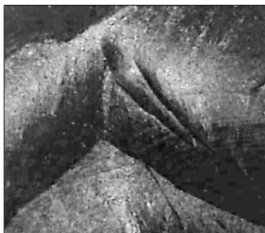
Ryc. 5. Mikroskopowe zdjęcie pokazujące wnętrze przełomu uszkodzenia powstałego w trakcie wypadku.
