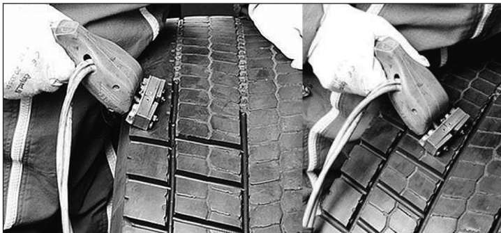
Ryc. 3, 4. Widok narzędzia do pogłębiania bieżnika i sposób wykonania tej czynności 6 .
