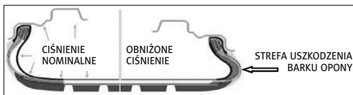
Ryc. 8. Schemat miejsca uszkodzeń barku opony w wyniku jazdy z zaniżonym ciśnieniem wewnętrznym.
