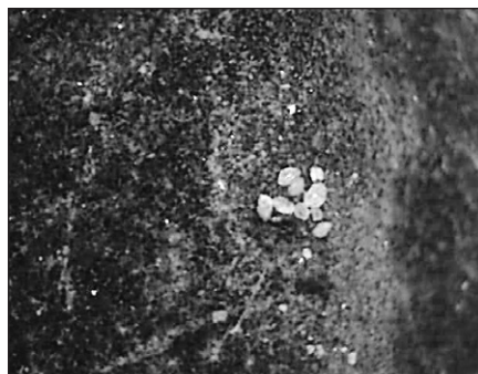
Ryc. 6. Mikroskopowe zdjęcie pokazujące wnętrze przełomu uszkodzenia powstałego przed wypadkiem. Wewnątrz widoczne wbite w ścianę ziarna piasku z nawierzchni.
