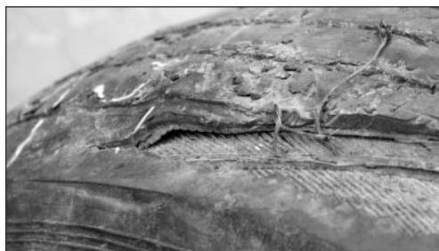
Ryc. 18. – Widok miejsca odseparowania dalszej części bieźnika w miejscu zerwania czoła opony.
