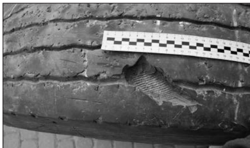
Ryc. 21. – Widok głębokiego uszkodzenia sięgającego pierwszej warstwy opasania. Wewnątrz widoczne są ślady korozji stalowej konstrukcji opony.
