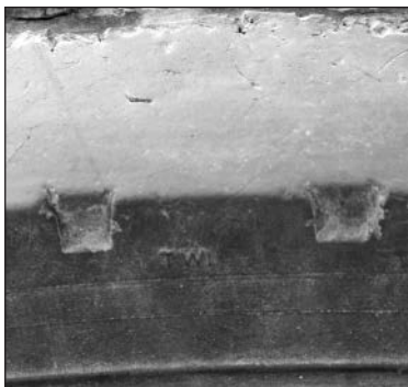
Ryc. 11. – Wskaźniki TWI po zewnętrznej stronie opony.
