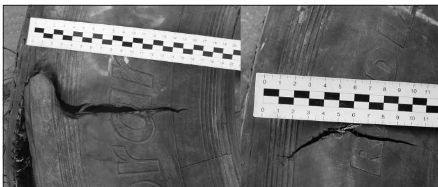
Ryc. 7, 8. – Uszkodzenia boku opony od strony wewnętrznej.
