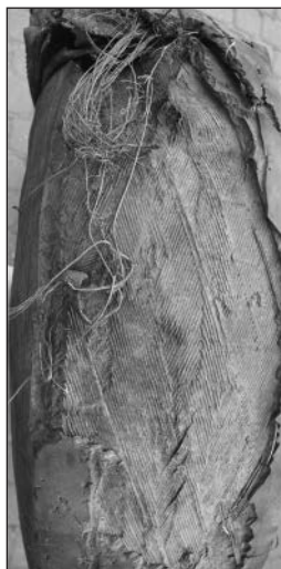
Fot. 17. – Widok odseparowanego fragmentu bieżnika na czole opony. W górnej części widoczne przelotowe uszkodzenie czoła i obu boków opony.
