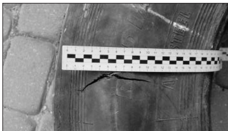
Ryc. 23. – Widok przelotowego uszkodzenia boku opony po stronie wewnętrznej. Uszkodzenie penetruje do stalowej konstrukcji opony.
