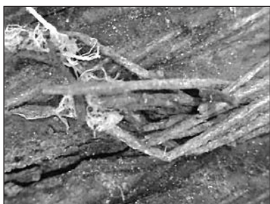
Ryc. 30, 31. – Mikroskopowy obraz miejsc zerwania stalowych linek stanowiących konstrukcję opony. Zerwanie nastąpiło pod wpływem działania siły rozciągającej. Widoczne powiększone ognisko korozyjne elementów splotu opasania.
