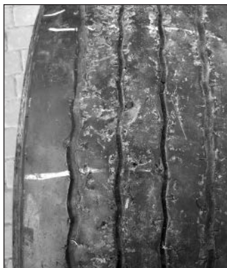
Ryc. 13. – Fotografia czoła bieżnika ukazująca jego stan oraz uszkodzenia wynikające z charakteru wcześniejszej eksploatacji.
