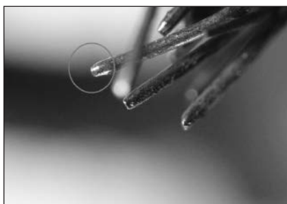
Ryc. 30, 31. – Mikroskopowy obraz miejsc zerwania stalowych linek stanowiących konstrukcję opony. Zerwanie nastąpiło pod wpływem działania siły rozciągającej. Widoczne powiększone ognisko korozyjne elementów splotu opasania.
