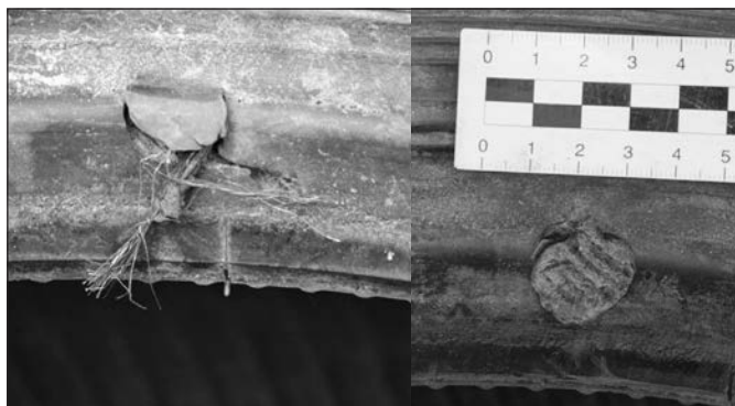
Ryc. 5, 6. – Uszkodzenia stopki opony, pierwsze penetrujące do warstwy „drutówki”, drugie powierzchniowe.
