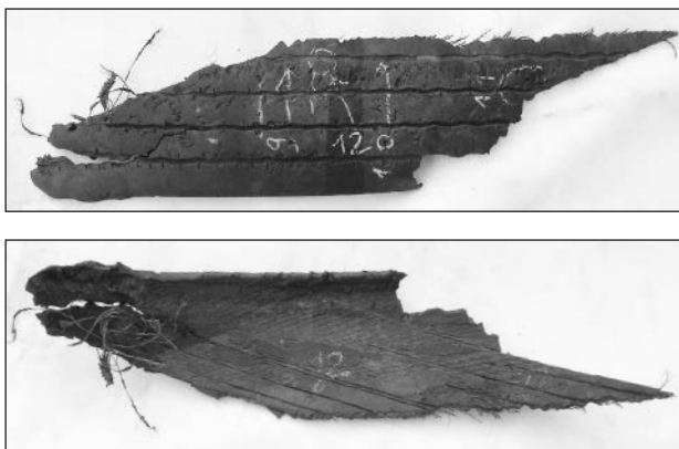
Fot. 28, 29. – Widok zewnętrznej i wewnętrznej części odseparowanej od karkasu opony warstwy bieżnika. Na stronie zewnętrznej widoczne uszkodzenia rzeźby bieżnika nieodbiegające cechami charakterystycznymi od uszkodzeń na pozostałej części opony. Na stronie wewnętrznej widoczne rozerwane fragmenty opasania opony z widocznymi wielomiejscowymi ogniskami korozji stalowych elementów konstrukcyjnych.
