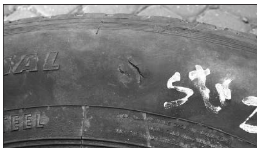
Ryc. 22. – Widok płytkiego uszkodzenia boku opony po stronie zewnętrznej. Uszkodzenie penetruje do stalowej konstrukcji opony.
