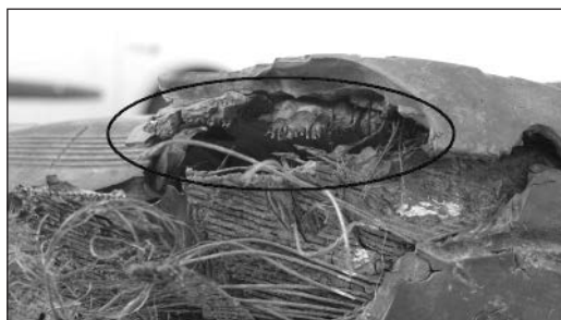
Ryc. 32. – Miejsce dekompresyjnego rozerwania zewnętrznego barku opony.
