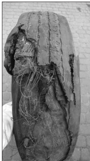
Ryc. 10. – Widok uszkodzenia czoła opony. Fotografia przedstawia zakres i obszar uszkodzenia czoła opony wraz z ubytkiem fragmentu bieżnika. Widoczne jest miejsce rozerwania opony oraz zerwane stalowe elementy konstrukcyjne opony.
