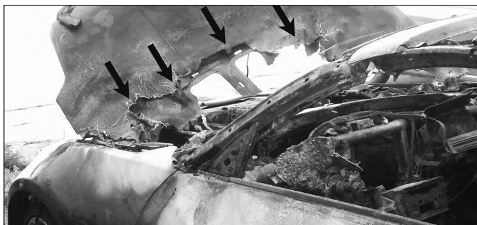
Ryc. 17. Widok uszkodzonej przez pożar tylnej krawędzi pokrywy komory silnika.
