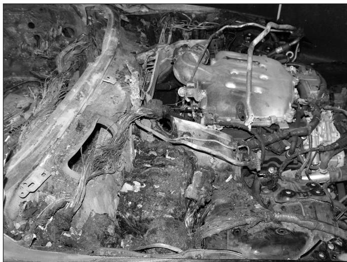
Ryc. 8. Zdjęcie przedstawiające uszkodzenia w komorze silnika oraz prezentujące fragmenty wiązek elektrycznych wewnątrz pojazdu i w komorze silnikowej.
