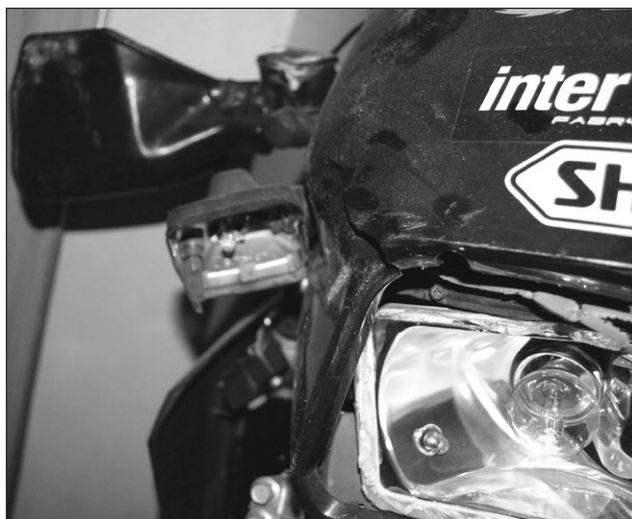
Ryc. 20. Żarówka R2 przed demontażem z motocykla marki Yamaha. Fotografia wykonana podczas ponownych oględzin jednoślada przeprowadzonych 22.12.2009 r.
