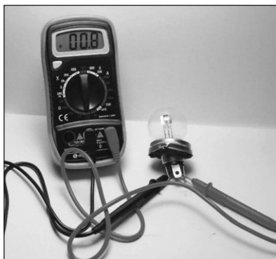
Ryc. 10. Pomiar ciągłości połączeń elektrycznych przeprowadzony w żarówce dowodowej R2.
