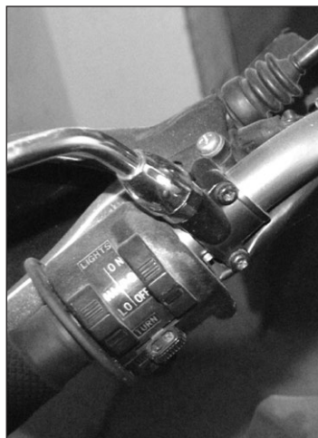
Ryc. 22. Pozycja włączników świateł na kierownicy motocykla.
