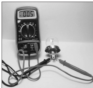
Ryc. 11. Pomiar ciągłości połączeń elektrycznych przeprowadzony w żarówce porównawczej R2.
