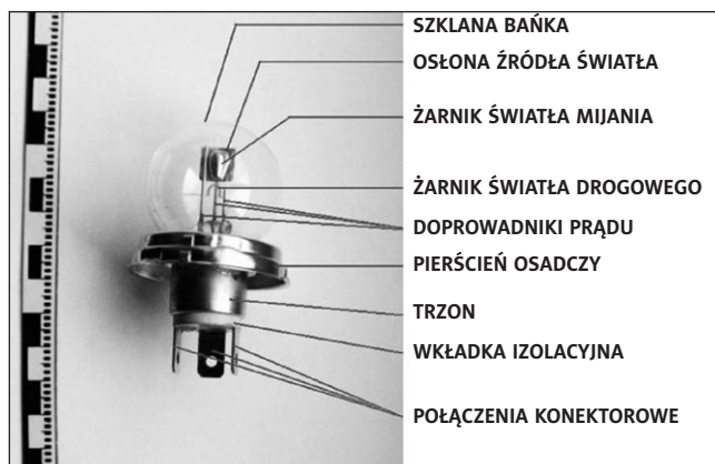
Ryc. 1. Budowa żarówki (na przykładzie żarówki typu R2).
