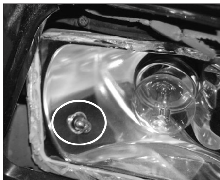
Ryc. 23. Żarówka światła pozycyjnego niezabezpieczona do badania.
