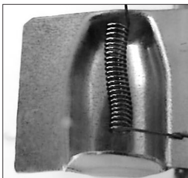
Ryc. 6. Mikroskopowe zdjęcie ukazujące żarnik światła mijania znajdujący się wewnątrz żarówki dowodowej.
