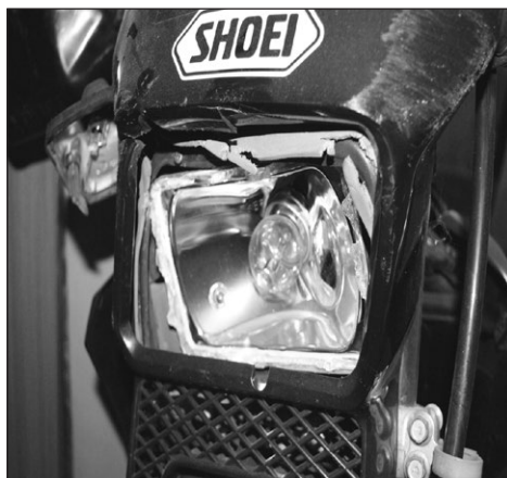
Ryc. 19. Rozbity reflektor główny wraz z żarówką R2.
