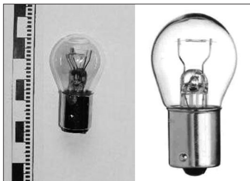
Ryc. 12, 13. Dowodowa żarówka P21/5W Stanley 12V zabezpieczona podczas oględzin motocykla Yamaha oraz żarówka porównawcza.
