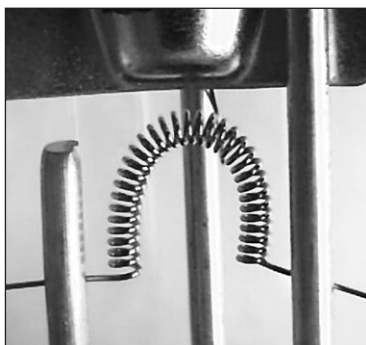
Ryc. 8. Mikroskopowe zdjęcie ukazujące żarnik światła drogowych znajdujący się wewnątrz żarówki dowodowej.
